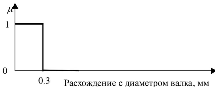
Рис. 7.8. Функция желательности фактора «Соответствие диаметру вала»
